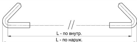
ВНУТРЕННЕЙ СТОРОНЕ КРЮКОВ (допуск: -0 / +10мм)
