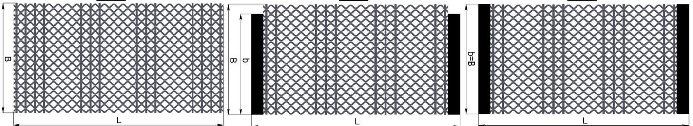
Арф. сита изготавливаются с металлическими переплетами, переплеты могут быть доп-но пролиты полиуретаном, варианты:
